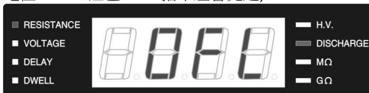
被測物(DUT)阻值不在量測範圍( $> 200.0\text{G}\Omega$  for 8210,  $>50\text{G}\Omega$  for 8205 )顯示
