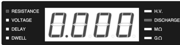
被測物(DUT)阻值不在量測範圍( $< 0.001\text{M}\Omega$ )顯示
