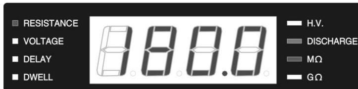
測試中止時量測到被測物阻值(180MΩ)顯示
