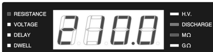
被測物(DUT)阻值超過設定值(210.0MΩ)顯示
