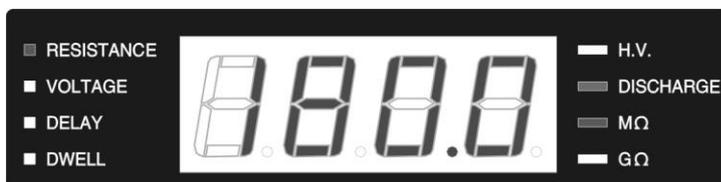
此畫面測試通過阻值( $180\text{M}\Omega$ )顯示
